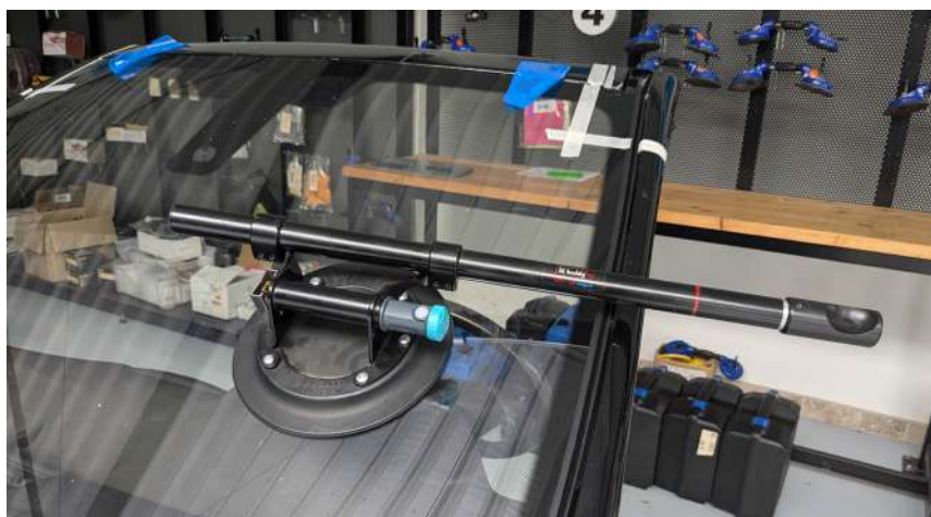
Système Lil.Buddy équipé d'une pompe sur batterie
