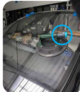
Système Lil.Buddy équipé d'une pompe sur batterie
