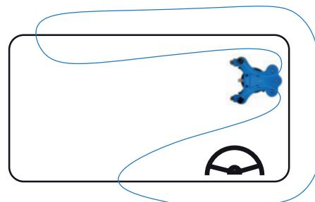
**5** - Coupez le long du toit et arrêter juste avant le coin. Puis le long de la partie inférieure du montant et ce jusqu'à ce que le pare-brise soit entièrement découpé.
