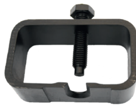
Arrache essuie-glace Utilisé pour les bras en plastique, généralement pour les lunettes arrière type Renault Espace/Scenic... REF : PP-WST51P
