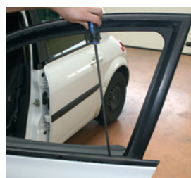
Outil de nettoyage glissière vitre de porte Dimension tige : 50 cm hors manche REF : PP-WST64
