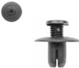
Rivet à visser Honda & usage général (x 20) Head : 20 mm • Stem : 11 mm Stem Diam : 8 mm • Couleur : noir Nylon OE : Honda 90675-SB3-003 Mazda FB01-56964 • Nissan 63876-95596 REF : 8216
