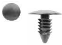
Agrafe sapin noire Ford & usage général Head : 18 mm • Stem : 16 mm Stem Diam : 7 mm • Couleur : noir Nylon OE : Ford 389358 • GM 332364 Chrysler 3691590 x10 : REF : P-F-0011-10 x50 : REF : 8184
