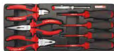
Module de tournevis / pinces isolées €10 8 pièces D6BC2106 • Pinces coupantes diagonales isolées VDE • L 6 D6BA2107 • Pinces multiples isolées VDE • L 8 D6BB2108 • Pinces isolées à bec long VDEL 8 FAEB0410 & 5E13 • Tournevis à fente isolée VDE 4 x 100 & 5,5 x 125 mm FBEB0110 & 0210 • Tournevis isolé Phillips PH1 x 100 & PH2 x 100 mm FAJA0315 • Testeur de tension, homologation GS/CE (L) 145 mm REF : TT-GAAT0809
