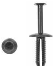
Rivet à enfoncer noir GM & Opel (x 50) Head : 15 mm • Stem : 20 mm Stem Diam : 6,5 mm • Couleur : noir Nylon OE : GM 1400806 • BMW 5111964186 REF : 8191
