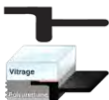
Profil universel « tenue extrême » PUGM1 • Profil PB 8 mm avec butyl rouleau 22,8 m • Avec adhésif REF : PP-JT088
