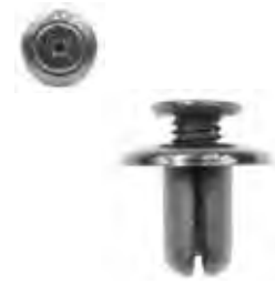
Rivet à visser Ford & usage général (x 50) Head : 18 mm • Stem : 12 mm Stem Diam : 8 mm • Couleur : noir Nylon OE : Ford MB45556143 KIA 0603250037A • Mazda 8092251833 Nissan 01553-0038U • REF : 8188
