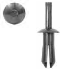
Rivet expansible noir Renault & usage général (x 50) Head : 10 mm • Stem : 15 mm Stem Diam : 5 mm • Couleur : noir Nylon OE - Renault 7703072144 REF : 8144
