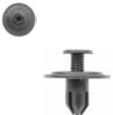
Rivet à visser noir Honda (x 50) Head : 18 mm • Stem : 10 mm Stem Diam : 6 mm • Couleur : noir Nylon OE - Honda 90688-SB0-003 REF : 8213
