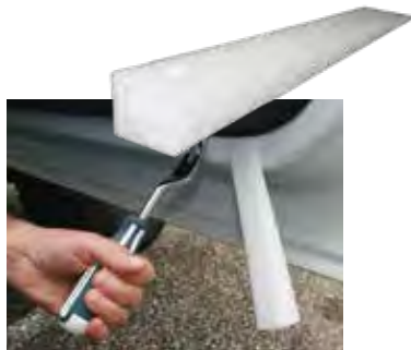
Coin nylon H : 25 mm - L : 190 mm - l : 30 mm Permet de mettre en tension les agrafes sans endommager la peinture REF : TT-JJAP1219
