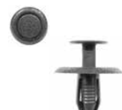
Rivet à enfoncer Mazda & usage général (x 50) Head : 18 mm • Stem : 10 mm Stem Diam : 6 mm • Couleur : noir Nylon OE - Mazda B46768AC3 REF : 8242
