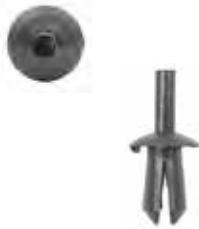
Rivet expansible noir Peugeot/Citroën & usage général (x 50) Head : 9 mm • Stem : 13,5 mm Stem Diam : 6 mm • Couleur : noir Nylon OE : Peugeot 6955.LE Renault 7703072116 REF : 8135
